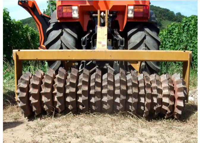
Abb. 20 Prismenwalze mit festen und losen Scheiben für eine optimale Bodenanpassung
