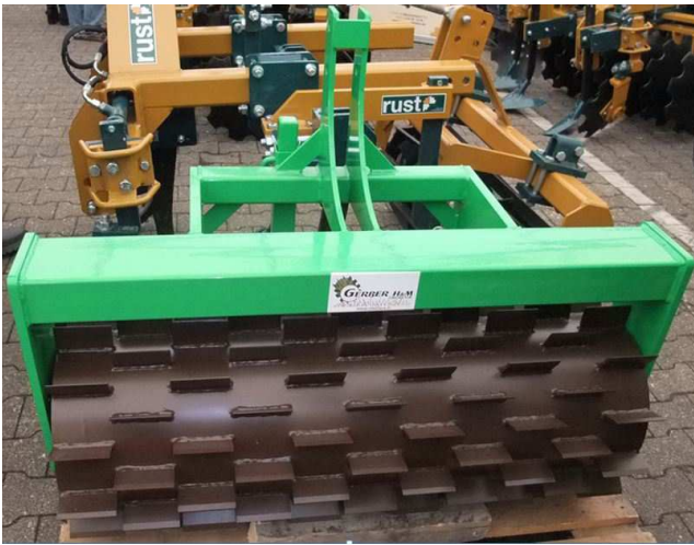
Abb. 17 Walze mit unterbrochenen Stegen
