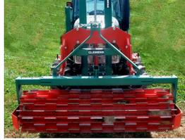
Walze mit durchlaufenden Stegen mit teilweiser Erhöhung
