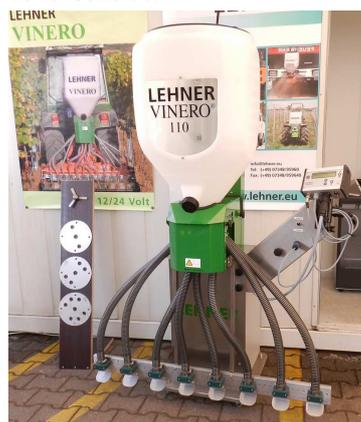
Pneumatische Sämaschinen und spezielle Kreiselstreuer mit einer bodennahen Saatgutablage über Schläuche ermöglichen auch eine gezielte Nachsaat in Fahrspuren oder die Ablage von granulierten Düngern im Unterstockbereich. Durch diese Streifendüngung kann das Wachstum in der Begrünung gebremst werden und der steht den Reben zur Verfügung.
