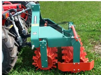
Doppelwalze mit Breitenverstellung durch Seitenverschiebung
