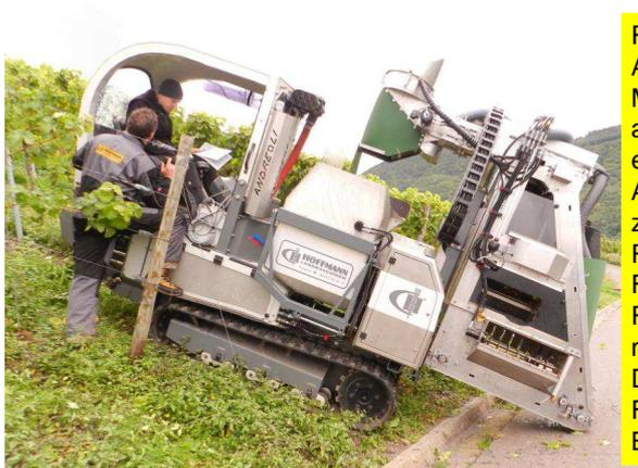
RMS-Raupen mit Anbaugeräten weisen Massen von 2,5 bis 5,0 t auf. Systembedingt erfolgt bei einem Arbeitsgang eine zweifache Überfahrt der Rebgasse. Folglich werden die Rebgassen bis zu 30 mal im Jahr durchfahren. Dies führt in den Fahrspuren u.U. zu Bodenverdichtungen
