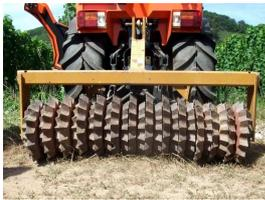
Prismenwalze mit festen und losen Scheiben für eine optimale Boden Anpassung
